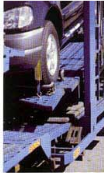
Gelochte Prägebleche sind rutschsicher, zweckmäßig und belastbar, nicht nur bei Nutzfahrzeugen
